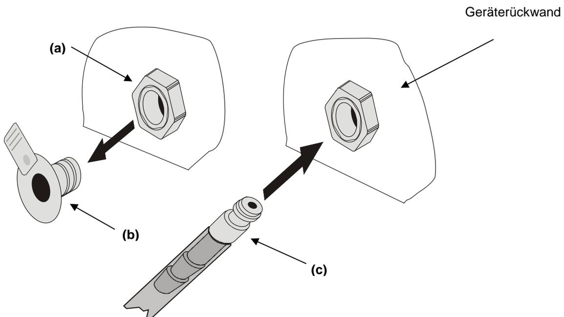
Abb. 12: Anschluss für die Schlauchverbindung zur Gasflasche
