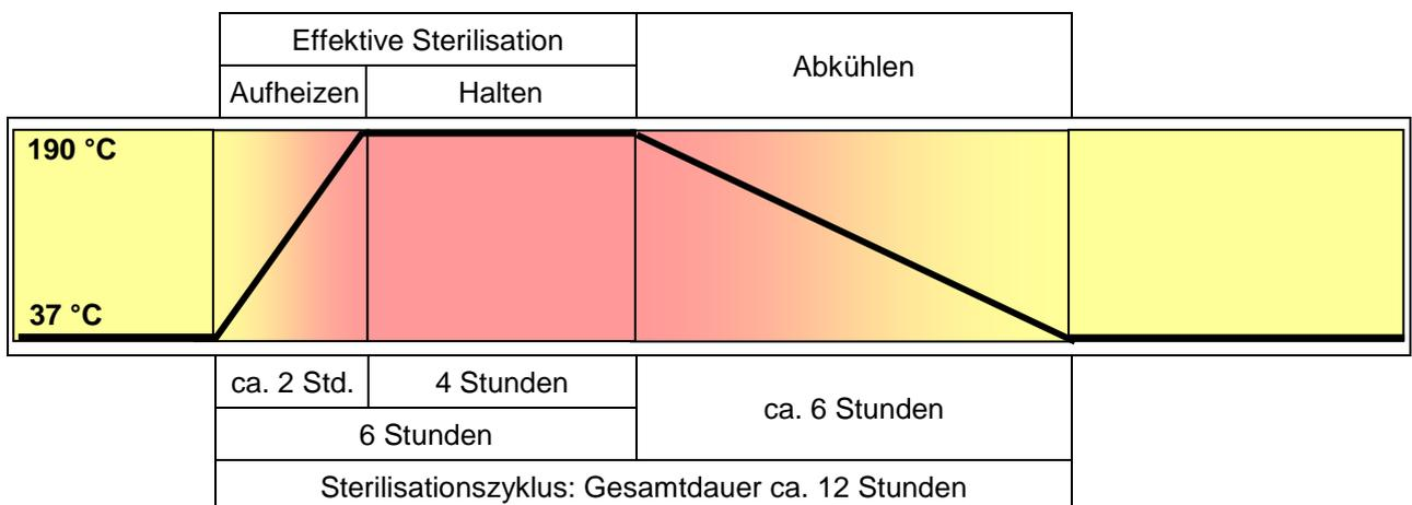
Abb. 21: Sollwertverlauf und Phasen des Sterilisationszyklus
