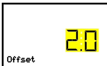
Einstellung des Überwachungsreglerwertes mit Überwachungsregler-Modus „Offset“
