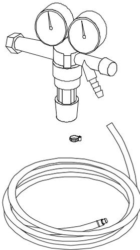
Das Gasflaschen-Anschlussset für CO<sub>2</sub> (Art. Nr. 8012-0014) beinhaltet die folgenden Teile zur Verbindung einer Gasflasche mit dem CO<sub>2</sub> - Inkubator:
