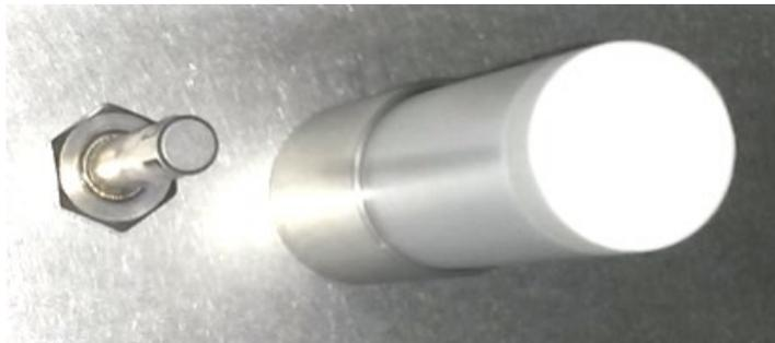
Abb. 10: Eingesteckter CO<sub>2</sub>-Sensor (rechts) und CO<sub>2</sub> Gasmischkopf
